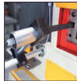
Elektrikli arka dayama (Çift pistonda standart) Electrical back gauge (Standard in double pistons) Электронный задний упор для настройки размера резки (стандартно для 2-х поршневых)
