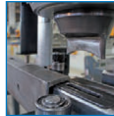
IPN/UPN ve Köşebent delme kalıbı IPN/UPN and angle punching tool Приспособление для пробивки IPN/UPN / уgolka
