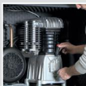
Dotados de un panel anterior practicable que facilita la accesibilidad y el mantenimiento de todos los componentes internos. El nivel de aceite es fácilmente visible y el rellenado resulta muy simple, gracias a la favorable posición del grupo cabezal
