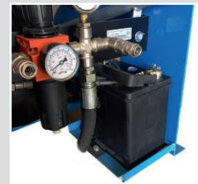
Incluye batería para el arranque eléctrico del motor gasolina
