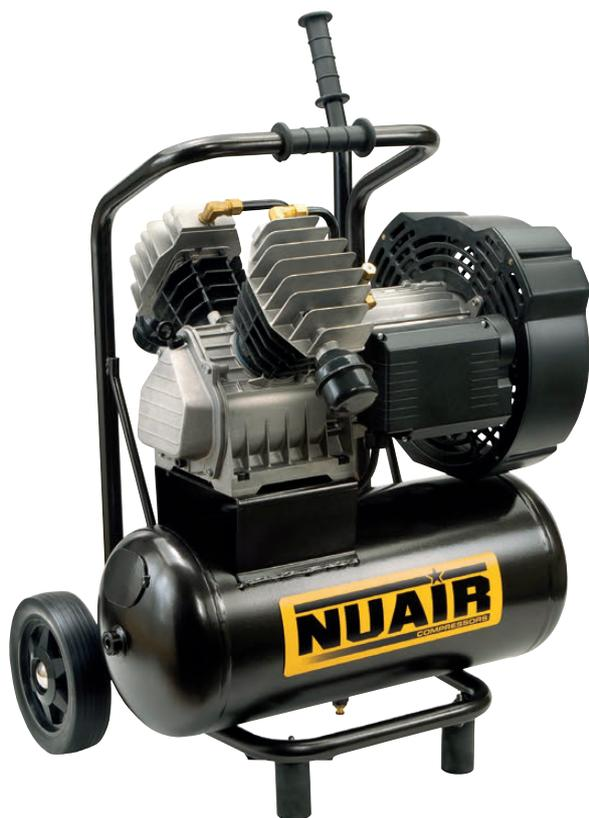
Compresor de pistón coaxial lubricado de 3hp, robusto y compacto, cilindro de hierro fundido y pistones en "V"; gran producción de aire, fiabilidad contrastada gracias a su motor de 4 polos de bajas revoluciones.
