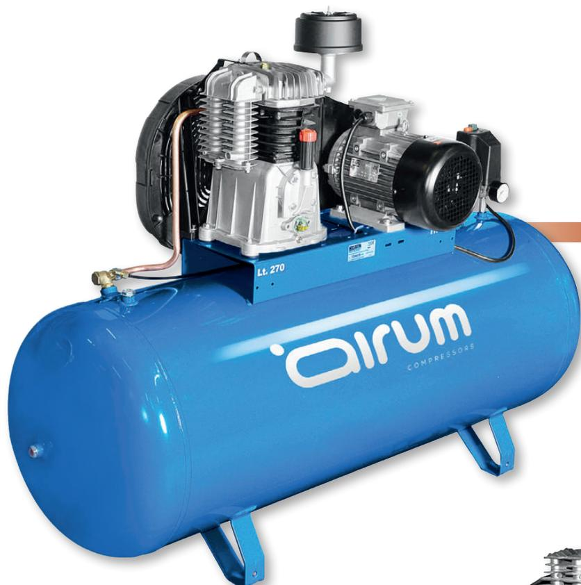
Grupo cabezal de doble etapa con cilindro de hierro, dotado de amplios colectores entre etapas y posterior, aleteados para mayor refrigeración. Filtro de aspiración de grandes dimensiones estudiado para reducir el sonido y optimizar el rendimiento del compresor.
